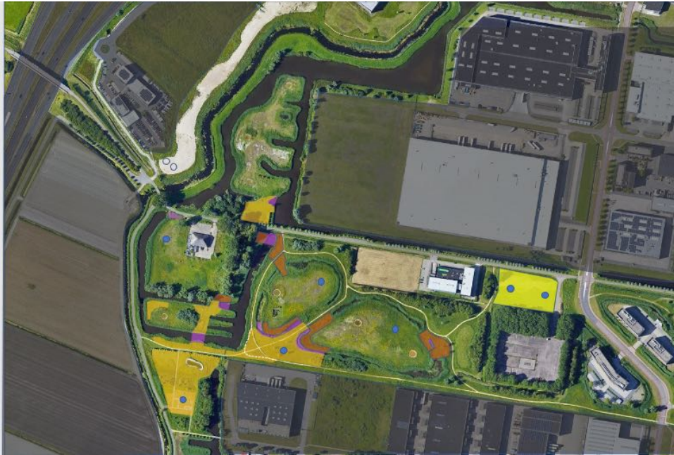
Figuur 14: Indicatieve visualisatie invulling fase 2 en 3 in het noordwestelijk deel van de ecozonestructuur. Fase 2: Geel=ophogen met schraal zand. Blauwe stip=nieuwe betonpoel aanleggen. Fase 3: paars is beperkte demping van waterdelen. Oranje is ophogingen op land om verbinding te verbeteren. Lichtgeel= aan te kopen en op te hogen kavel, nu nog periodieke bollenakker. De uiteindelijke exacte oppervlakte en begrenzing van op te hogen terreindelen en ligging van poelen moet nader worden uitgewerkt en kan dus enigszins anders zijn.
